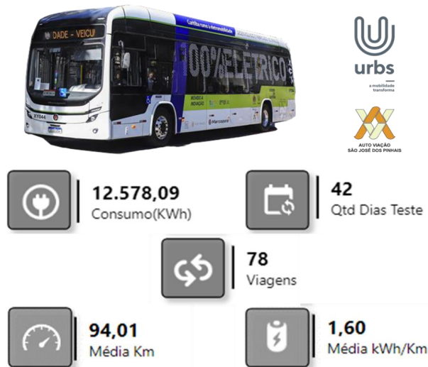
Figura 7 Desempenho operacional do veículo XY044 XY044 – Marcopolo Padron (Sem AC)
